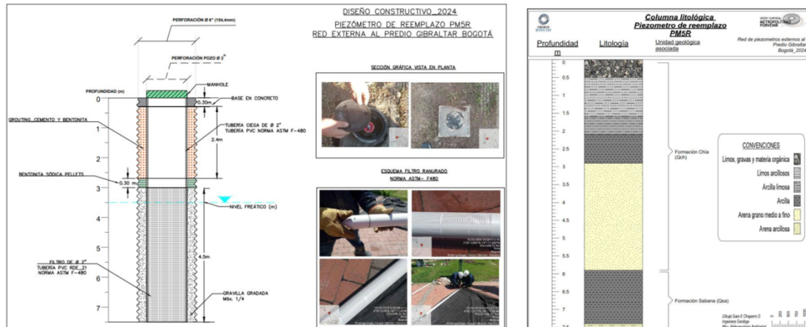
Figura 4. Diseño pozo de monitoreo PM5R
